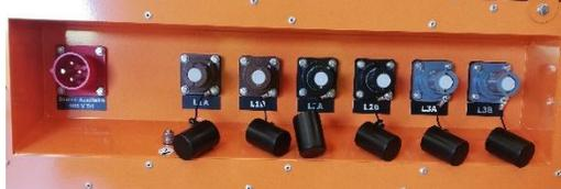
Raccordement 200 / 300 kW : 2 câbles par phase + terre
